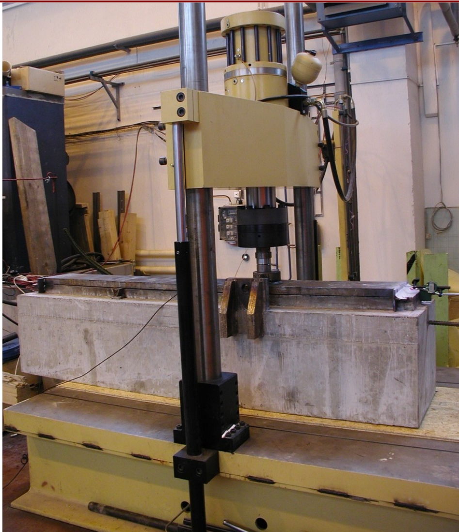
Schéma zatížení zkušebního vzorku na zařízení GTM Typ AH 500 - 150 M 161 s kapacitou 500kN, umožňující statické a dynamické zatěžování do 500kN
