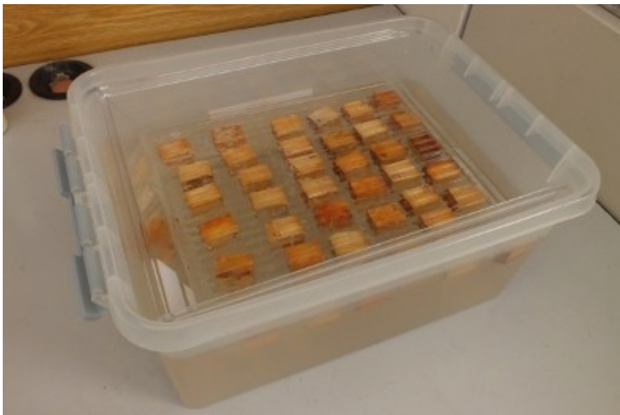
Zkušební vzorky v průběhu zkoušek fyzikálních vlastností
