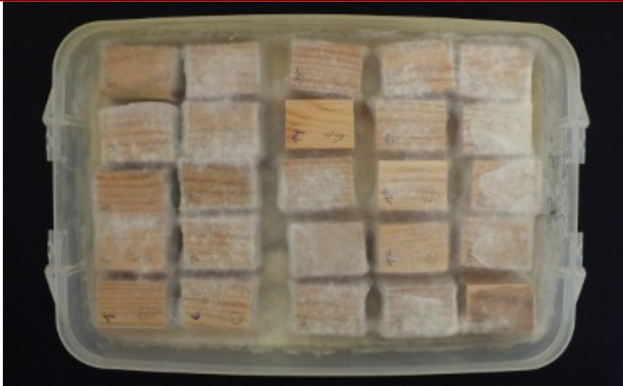
Zkušební vzorky v průběhu vystavení působení jednotlivých druhů dřevokazných hub
