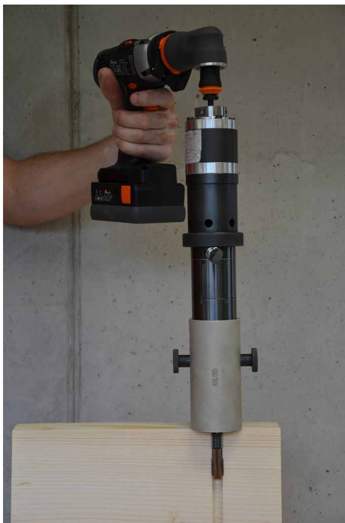
Nová metoda diagnostiky dřeva - roztlačování čelistí ve vrtu
