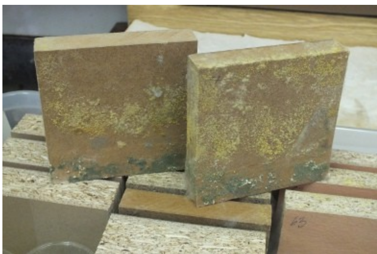
Laboratorní experiment k ověření druhového spektra plísní vyskytujících se v zatopených objektech krátce po opadu povodňové vody
