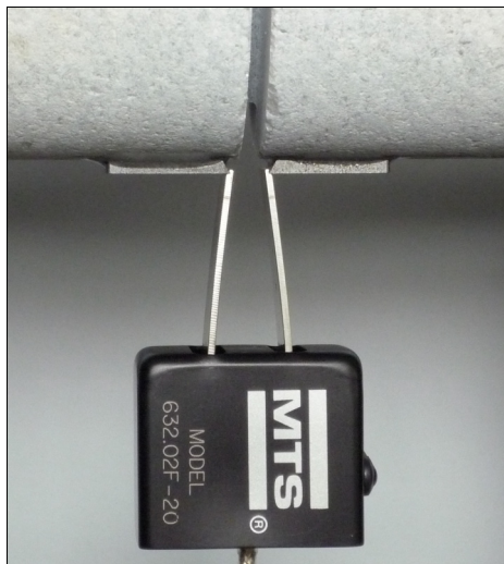
Obr. 5. Detail přichycení extenzometru ke vzorku Fig. 5. Detail of the attachment of the extensometer to the specimen
