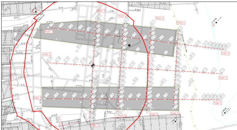
Obr. 1. Návrh a realizácia pozorovacej geodetickej siete Fig. 1. Draft and Realization of an Observation Geodetic Network
