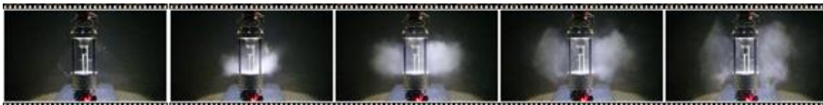
Obr. 2: Videosekvence rozptylovaného vzorku po dobu 100 ms
