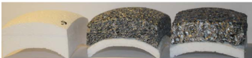
Testované vzorky (polystyren, sandwich polystyren a Alporas, sandwich polystyren a Aluhab); Průběh pádové zkoušky makety hlavy s testovanou sandwichovou strukturou ochranné přilby
