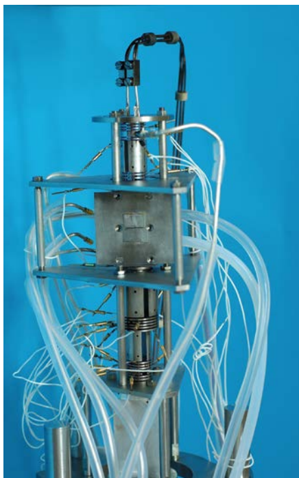
Trochoidální elektronový spektrometr, který slouží k výzkumu nízkenergetických elektronových srážek
