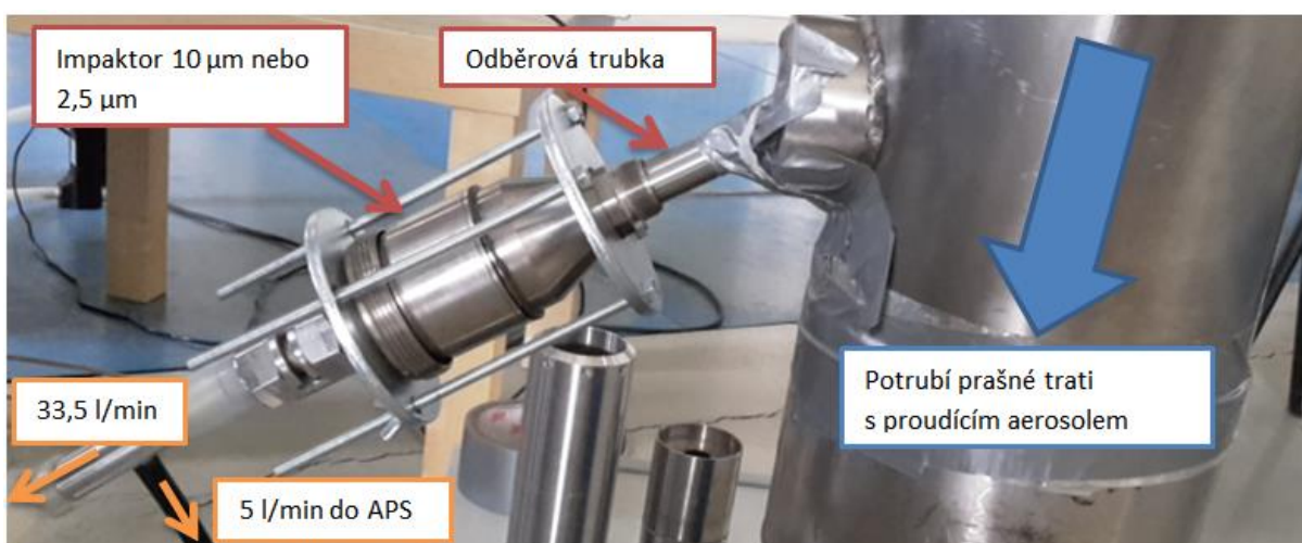
Obr. č. 2 Konfigurace b) a c) s impakčním stupněm 10 µm nebo 2,5 µm.
