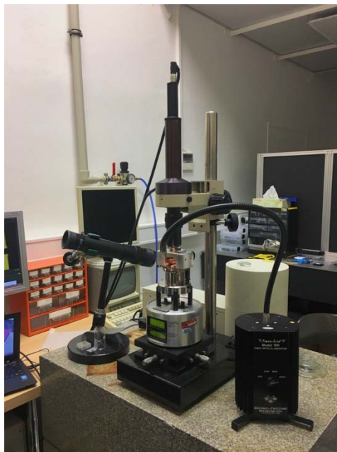
Obr. 2.: Mikroskop atomárních sil, kterým jsou pohyby nanorole pozorovatelné
