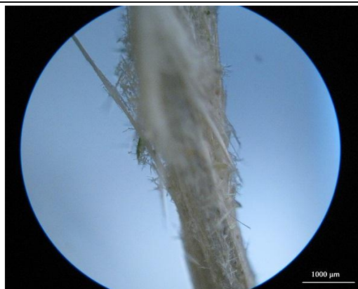
sObr. 3: Makroskopická vlákna aktinolitu z Plzně v optickém mikroskopu.
