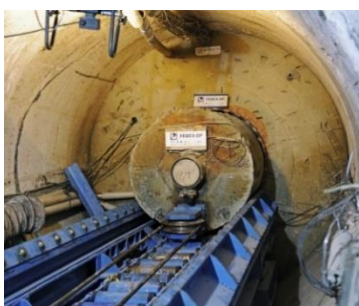
Obr. 16 Úloha multifyziky (termo-hydro-mechanika) - analýza FEBEX in-situ experimentu (Full-scale Engineered Barriers Experiment) realizovaného v laboratoři Grimsel (obr. vlevo). Vpravo výsledky výpočtů saturace bentonitového těsnění po 5 letech provozu a srovnání s měřenou vlhkostí (červená linie odpovídá měřícím bodům nejbližší tepelnému zdroji).
