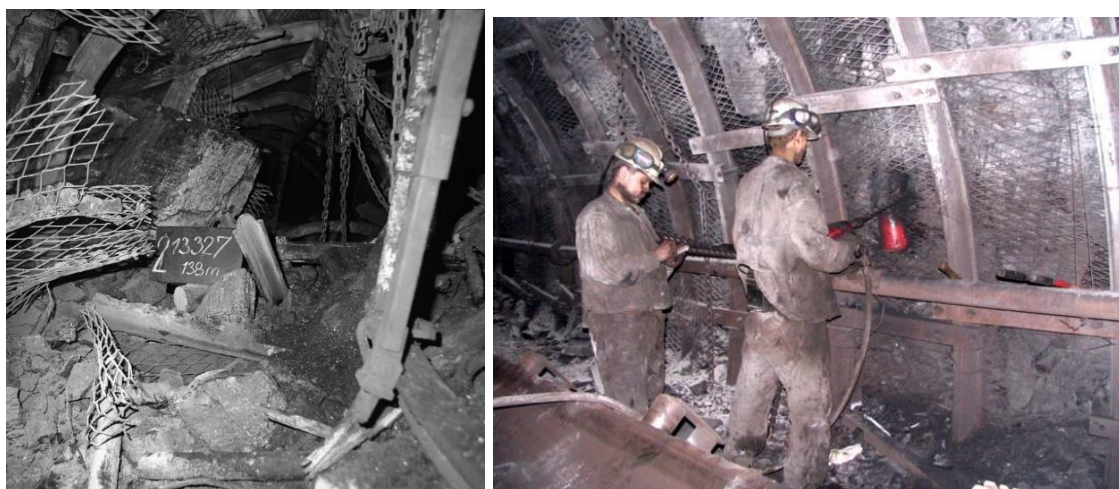
Obr. 10 a) Následky důlních otřesů, b) Testování stavu napětí v uhelném pilíři
