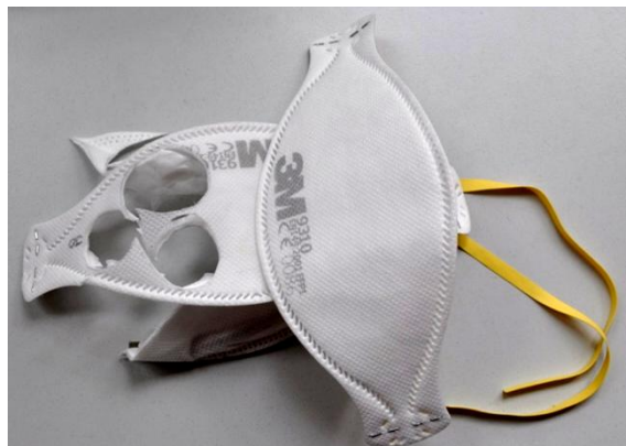
Obr. 1: Proměřovaná filtrační polomaska 3M, model 9310 před testem a po něm.
