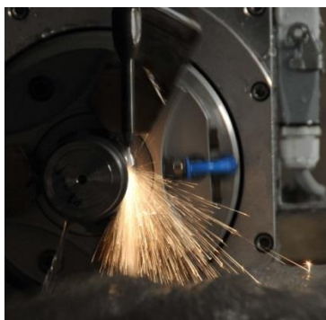
Obr. 1. Soustružení slitiny titanu pomocí AWJ. Na obrázku je vidět polotovar ze slitiny titanu upnutý v pneumatickém sklíčidle, který je obráběn pomocí AWJ. Při interakci abrazivních zrn s obráběným materiálem dochází vlivem tření ke vzniku jisker. Tento světelný efekt je typický pro obrábění titanu a jeho slitin pomocí AWJ, ale může být pozorován i u některých horninových materiálů.
