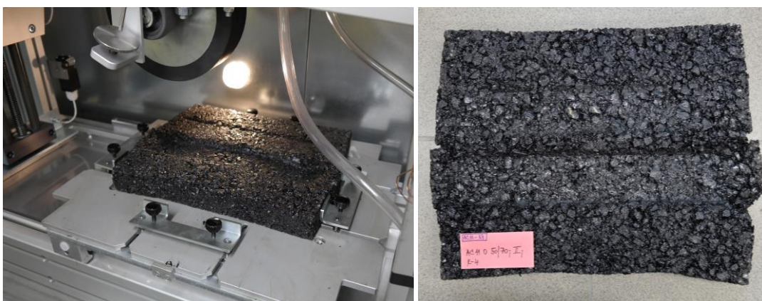
Obr. 2: Vzorka vyjazdenej asfaltovej zmesi - AC11 O 50/70, II, K-4
