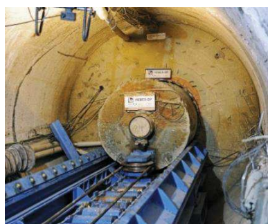
Obr. 22 Úloha multifyziky (termo-hydro-mechanika) - analýza FEBEX in-situ experimentu (Full-scale Engineered Barriers Experiment) realizovaného v laboratoři Grimsel (obr. vlevo). Vpravo výsledky výpočtů saturace bentonitového těsnění po 5 letech provozu a srovnání s měřenou vlhkostí (červená linie odpovídá měřícím bodům nejbližší tepelnému zdroji).
