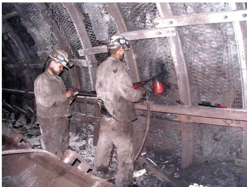
Obr. 12 Testování napjatosti uhlénoho pilíře
