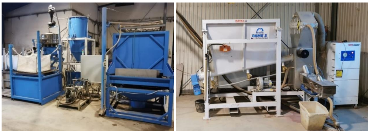
Obr. 6 Třídící jednotka (vlevo) a sušící jednotka (vpravo) v testovacím provozu
