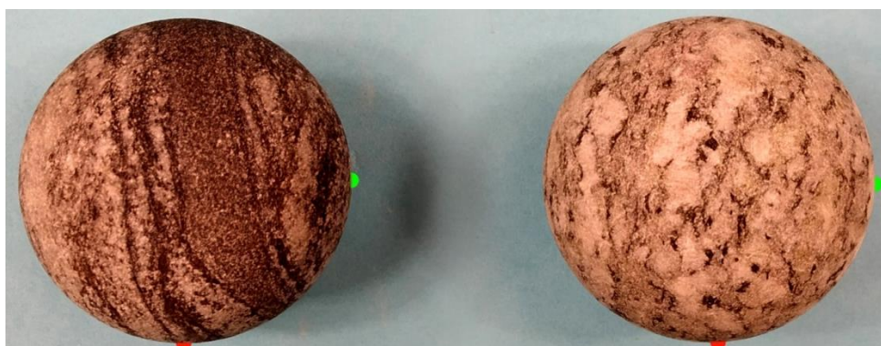
Obr. 9 Vybrané kulové vzorky hornin anizotropního materiálu
