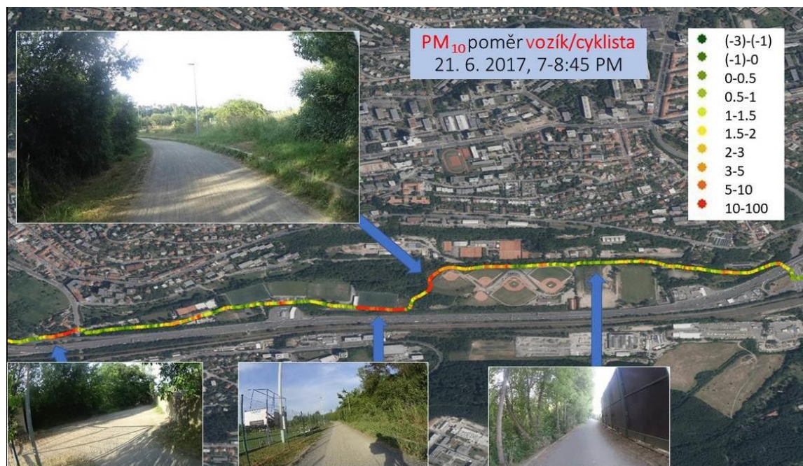
Obr. 2: Poměr PM 10 koncentrací ve vozíku/na řídítkách, červené úseky odpovídají prašným komunikacím, Praha-Braník, 21. 6. 2017, 19:40-19:50
