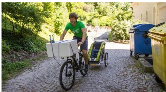
Obr. 1: Dvojice přístrojů DustTrak DRX a PTrak umístěná na řídítkách a ve vozíku
