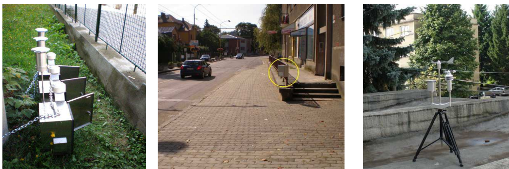
Obr. 1: Meracie stanovište – Žilina, mesto (vzorkovače Leckel LVS3 vľavo, sčítacie zariadenie dopravy SIERZEGA SR4 v strede a meteostanica WS 888 vpravo)
