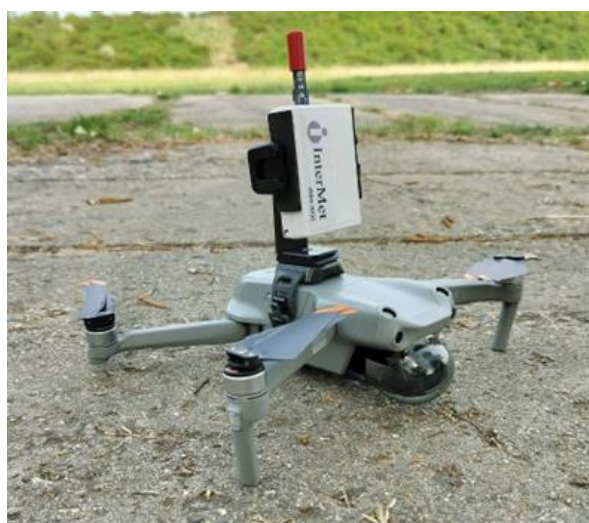
Obrázek 1: Vlevo, foto umístění monitoru na dronu s teplotním senzorem opatřeným červenou krytkou. Vpravo, vertikální profil T měřený směrem nahoru (červeně) a směrem dolů (modře), 17.09.2024, 14:42 – 14:47 (nad loukou)
