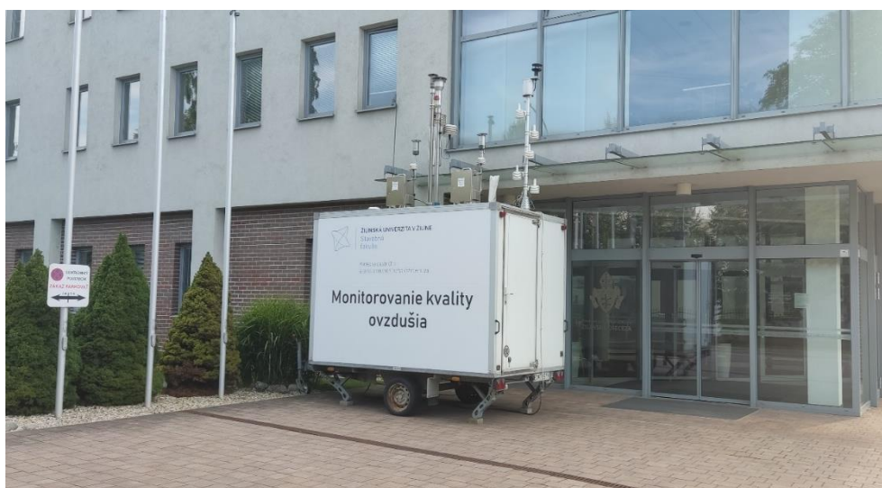
Obr. 3: Porovnávacie merania smart senzorov SM na meracom stanovišti v centre mesta Žilina
