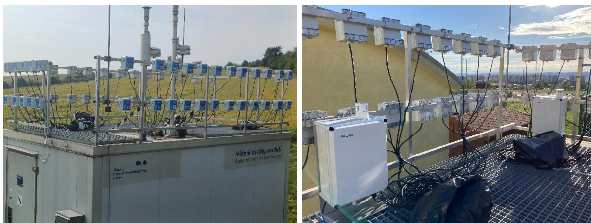
Obr. 3: Souměření sensorických jednotek na stanici AIM Těšovice
