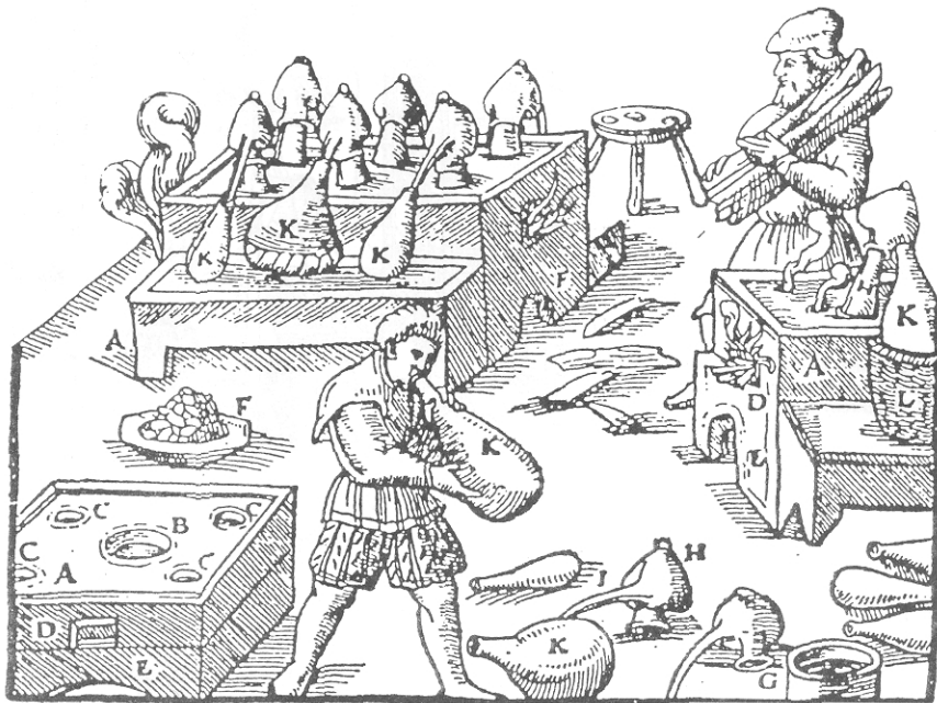
Obr. 9. Vlevo dole a vpravo pece k destilaci, nahoře pec k žhání a destilaci s baňkami v písečné lázni (Agricola 1933, obr. s. 378: „Pec A. Její okrouhlý otvor B. Průduchy C. Ústí peci D. Popelník pod ním E. Pánev F. Baňka G. Poklop H. Jeho nosák I. Jiná baňka K. Košík na uložení baňky, aby se nerozbila L.“)
