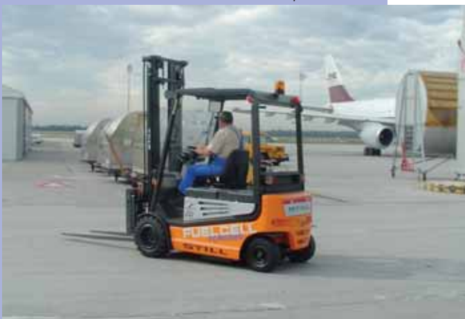
Vysokozdvizný vozík s vodíkovým pohonem byl v Německu ověřován při provozu na letišti
