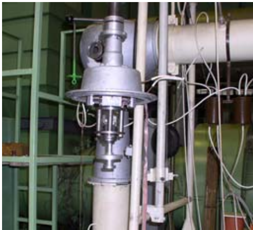
Obr. 1: Aerodynamický tunel na testování ventilů
