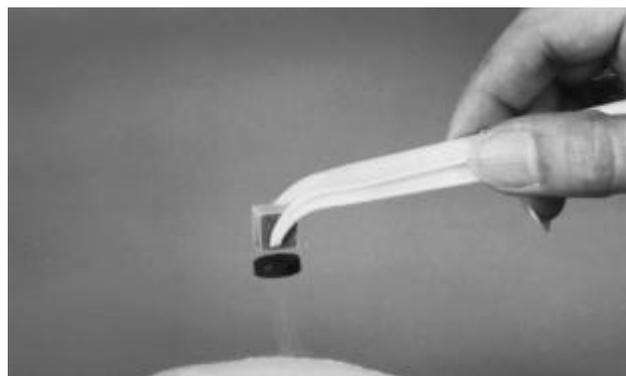
**Abbildung 13: Supraleiter „schwebt“ unter einem Magneten.**
