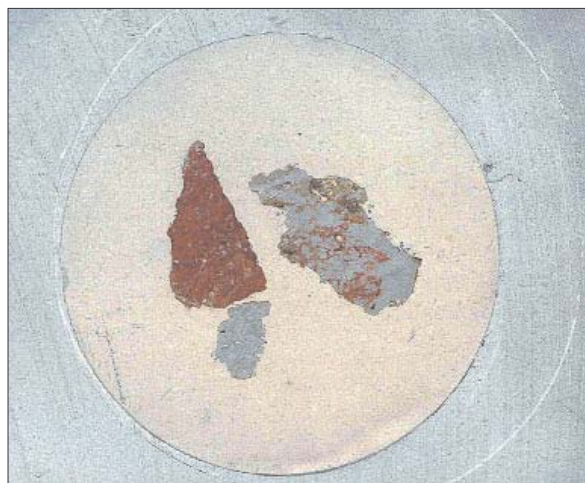
Obr. 13. Vyseparované klasty ostřiva z materiálu dlaždic sázavského kláštera (zvětšeno 4x, SCAN – DIA nástavec): část ferikrusty a dva úlomky granitické horniny. — Fig. 13. Clasts separated from grog in tiles from the Sázava monastery (4x magnification, SCAN – DIA extension): part of a ferricrete and two fragments of granitic rock.
