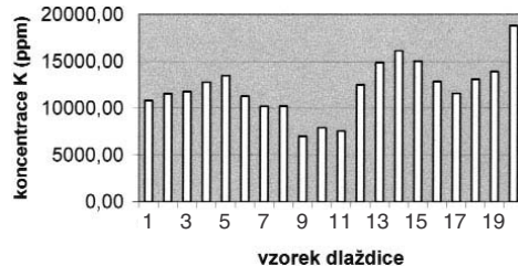
Obr. 25. Schematické vyjádření obsahu draslíku v materiálu studovaných terakotových dlaždic (číslování vzorků odpovídá tab. 7). — Fig. 25. A diagram of potassium content in the studied terra-cotta tiles (for sample numbers see Tab. 7).
