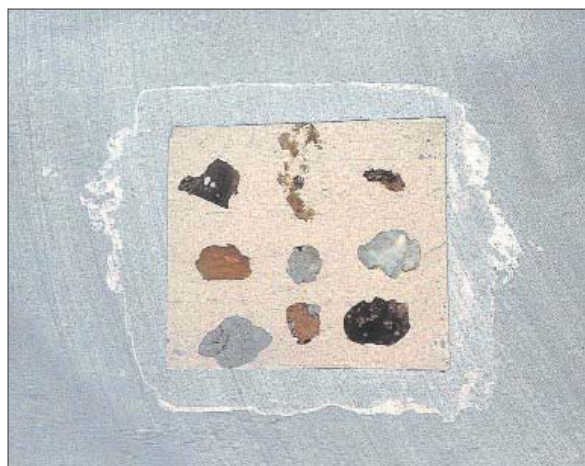
Obr. 14. Vyseparované drobné klasty ostřiva z materiálu dlaždic ostrovského kláštera (zvětšeno 4x, SCAN – DIA nástavec): úlomky kyselých vyvěřelých hornin a ferikrusty, úlomek jílovité břidlice, alterované zrno draselného živce a relikty alterovaného původního minerálu či horniny. — Fig. 14. Fine clasts separated from grog in tiles from the Ostrov monastery (4x magnification, SCAN – DIA): fragments of acidic effusive rock and ferricrete, fragment of shale, altered grains of K-feldspar, and a relict of the altered original mineral or rock.
