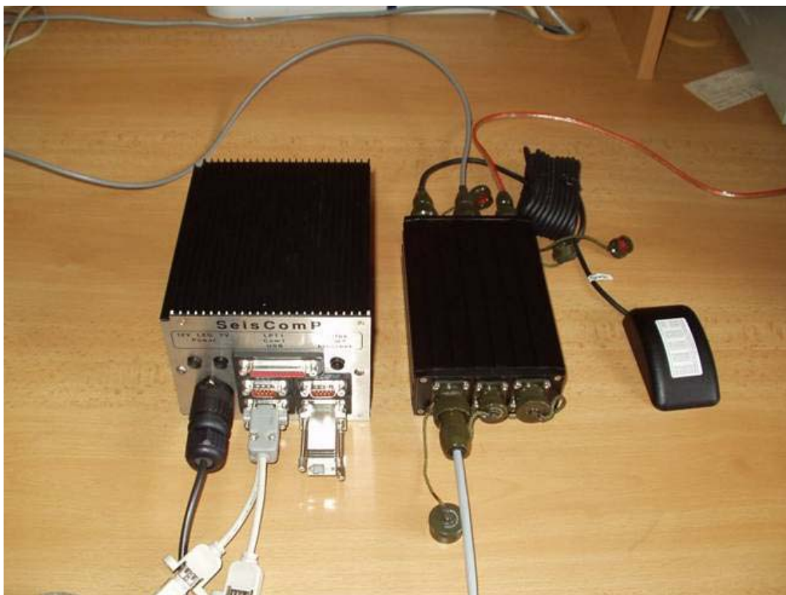
Obrázek 1. 24 bitový digitizér EarthData a registrační zařízení SeisComp, kterými je vybavena většina seismologických observatoří Geofyzikálního ústavu AV ČR.
