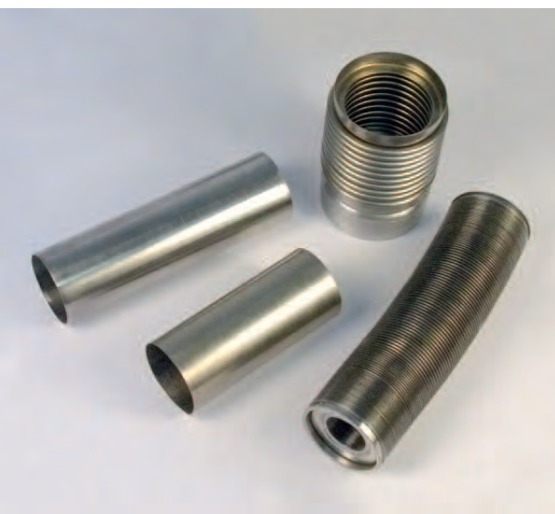
Příklady vakuových komponent svařovaných elektronovým svazkem
