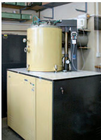
Modernizovaná vakuová pec PZ 810.
