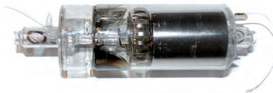
Finální He-Ne laser (nahore) a jeho klíčová část – výbojová trubice z křemenného skla (vlevo).
