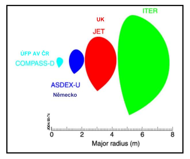
COMPASS-D je relativně malý tokamak, ale má geometrií podobnou ITER (1:10)
