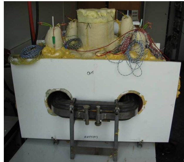
Celková sestava supravodivého transformátoru s teplým toroidálním jádrem a kryostatem, ve kterém je v kapalném dusíku uloženo supravodivé vinutí.
