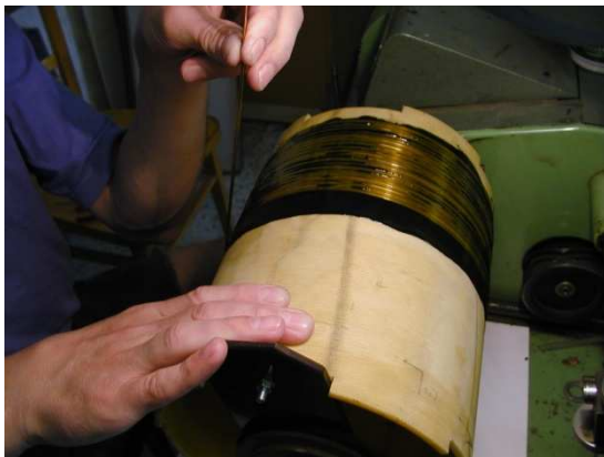
Navíjení primárního supravodivého vinutí.
