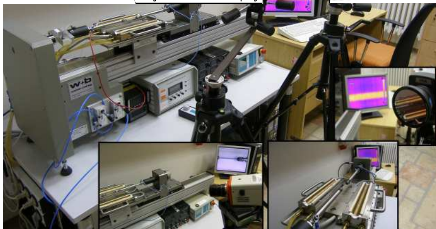
In situ nedestruktivní kontrola NiTi drátů, hybridní textilie
