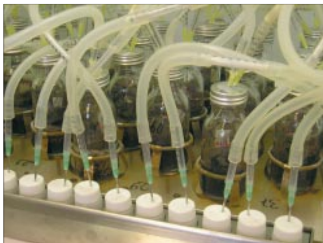
Obr. 3.: Pro studium transformace organických látek v půdním prostředí se využívají mikrokosmy s přidávkou sloučenin, označených isotopem uhlíku ^{14}\text{C} . Pokusy umožňují charakterizovat a kvantifikovat produkty rozkladu.
