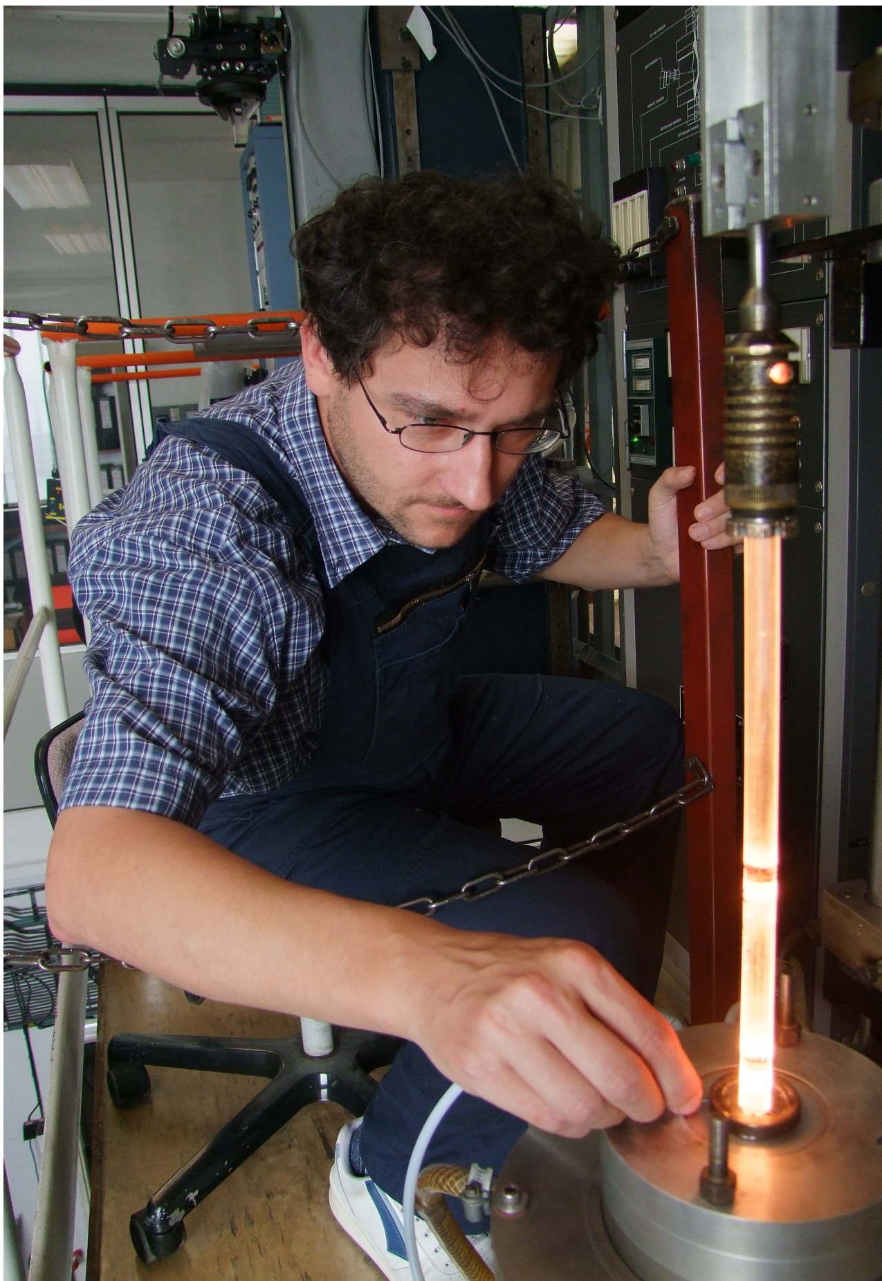
Obr. 7 Preforma optického vlákna zasunutá do grafitové pece v nejhořejší části jedné ze dvou tažících věží pro přípravu experimentálních optických vláken v ÚFE.
