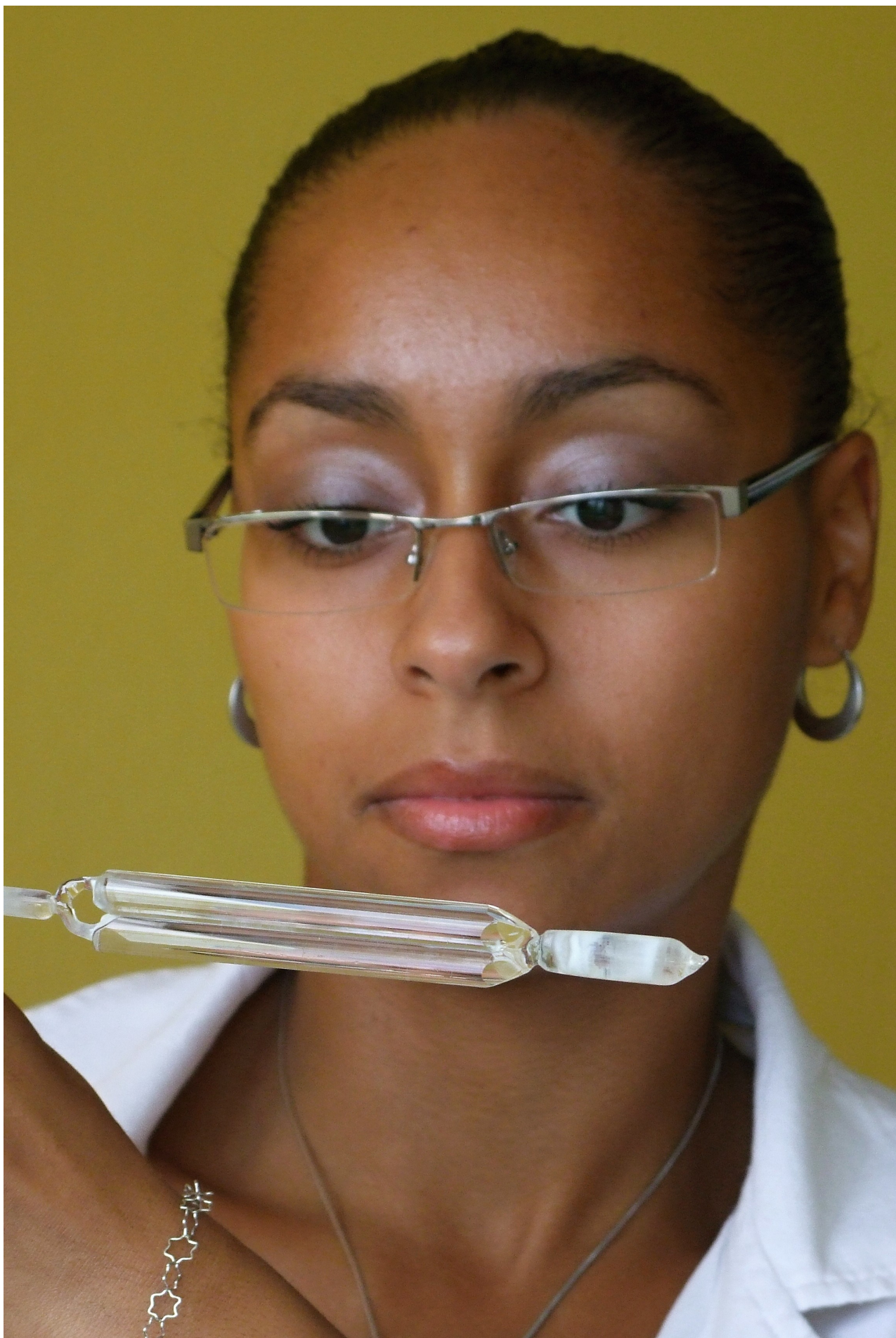
Obr. 8 Příklad preformy dvouplášťového optického vlákna s nekuhovým průřezem pro snadné navázání čerpacího a signálového vlákna připravené v ÚFE.
