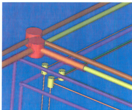
Obr. 2: Schéma osazení vakuových bloků s polohovacími jednotkami optických zrcadel v systému distribuce laserových svazků. Bloky zrcadel budou umístěny v místě změny směru svazku, respektive v místě volitelného přepínání chodu svazku do různých experimentálních hal. Vakuové bloky budou upevněny na stropní desku ve vzdálenosti 1 až 2 m (bude upřesněno objednatelem).
