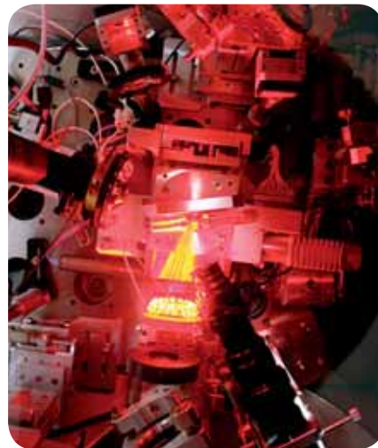
Pohled do interakční komory laserového systému PALS při experimentu s plazmovým rentgenovým laserem
