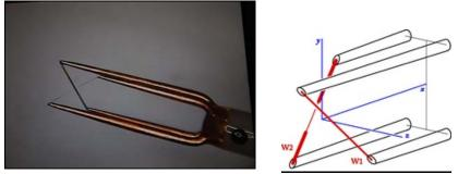
Fig. 4: X-sensor probe R511
