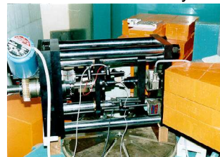
In-situ difrakce neutronů během tahové zkoušky
