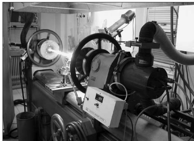
Obr. 2 Příprava preformy metodou MCVD (kolaps)
