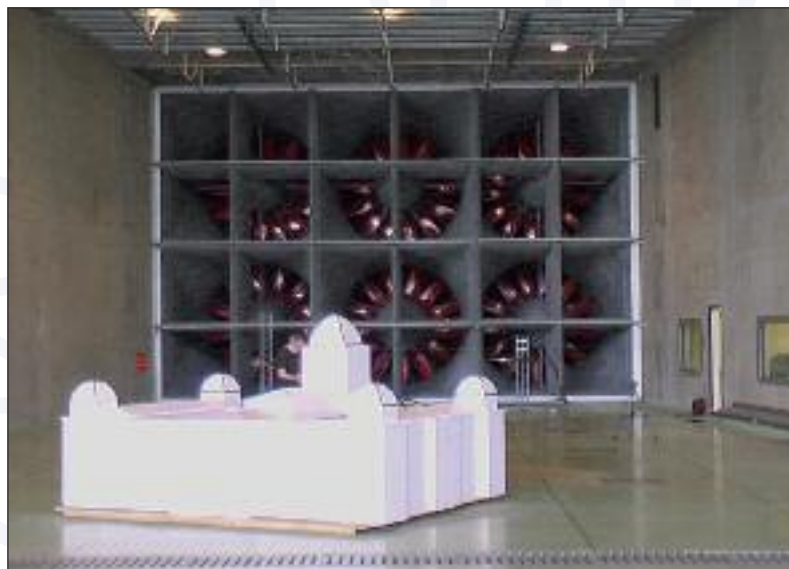
Studium vlivu větru na znečištění fasád budovy Národního muzea v Praze v klimatickém větrném tunelu „Jules Verne“ v Nantes
