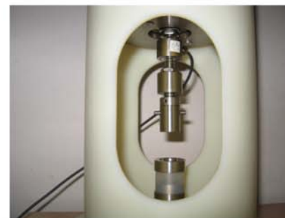
detail enviromentální komory a zatěžovacích čelistí
