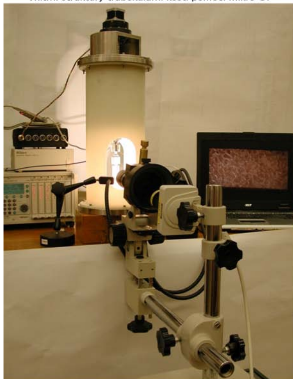
sledování deformace na povrchu vzorku trabekulární kosti kamerou s vysokým rozlišením
