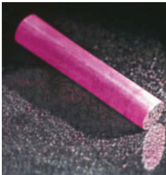
Obr. 2 Rubínový krystal s odraznými zrcadly na čelních plochách.
