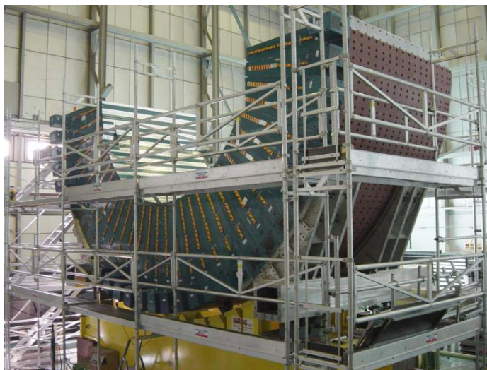
Obr.15: Testovací sestavení hadronového kalorimetru TILECAL v pozemní hale v CERN.
