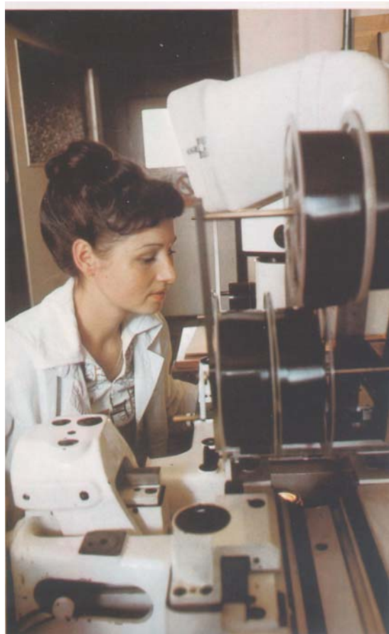
Obr. 5. Vyhledávání a proměřování srážek antiprotonů s protony na fotografických snímcích z bublinových komor prováděly naše laborantky na poloautomatických strojích. Na snímku vpravo je případ srážky antiprotonu s protonem, v níž vznikl jeden neutrální a 6 kladně a 6 záporně nabitých pionů.
