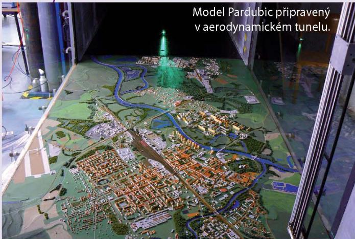
Model Pardubic připravený v aerodynamickém tunelu.
