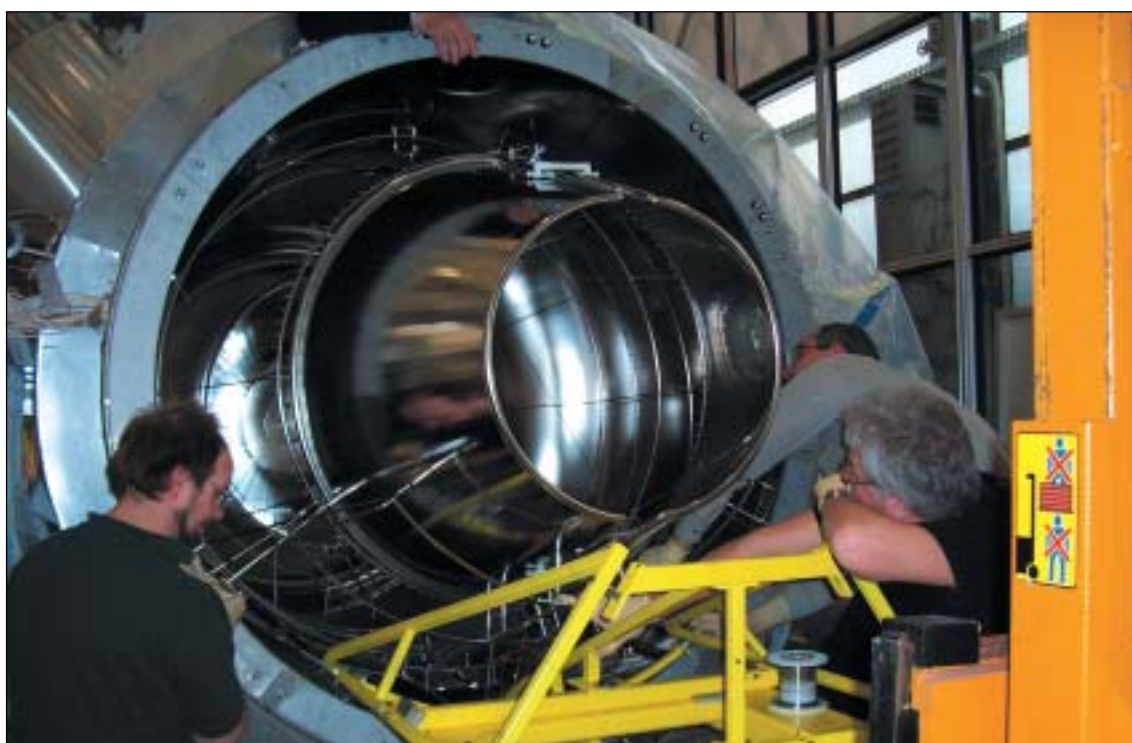
Montáž retardačních elektrod do vakuové komory předsaženého spektrometru KATRIN
