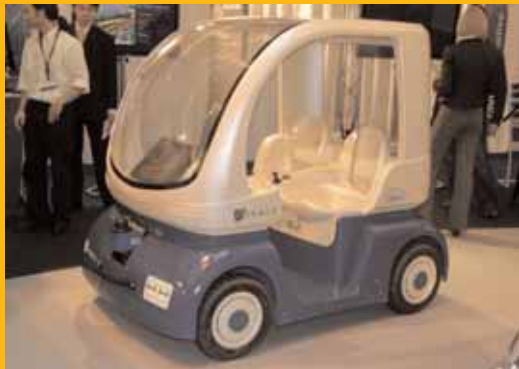
Vozidlo pro provoz bez řidiče - projekt 6. RP CITYMOBIL
