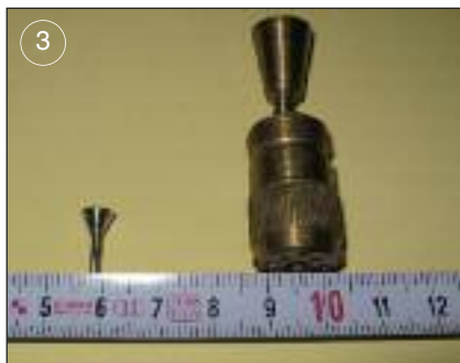
Nejmenší testovaná odvalovací turbína měla průměr rotoru 6 mm – vlevo (obr. 3).
