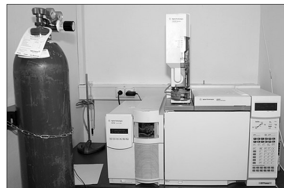
GC/MS – kvadrupól 5975B MSD (LR malé molekuly; EI)
