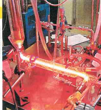
» Výbojová kvjeta sloužící k vytvoření iontů
