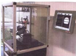
Obr.5 Automatická kontrola kulových ploch náhrad kyčelních kloubů
