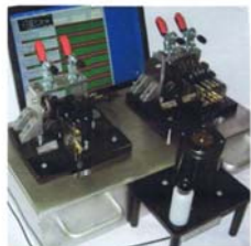
Obr.7 Provozní kontrola kulových čepů vícenásobným komparačním měřicím pracovištěm
