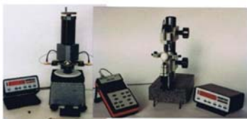
Obr.2 Provozní měřidlo \phi a rozptylu \phi kulových ploch
