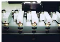
Obr.1 Snímače pro měření tepelné roztažnosti materiálů ve stomatologii
