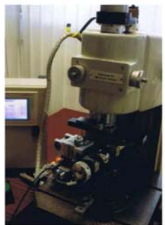
Obr.6 Laboratorní měření kulovitosti kouli
