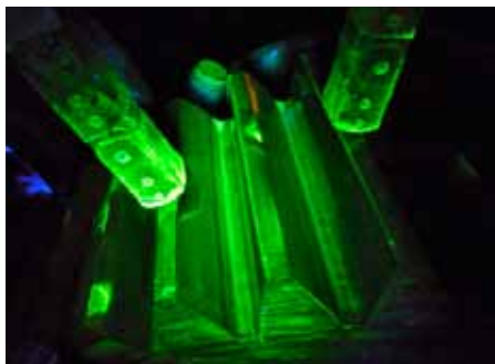
Testování pomocí fluorescenčních magnetických částic (foto: DCLENG)
