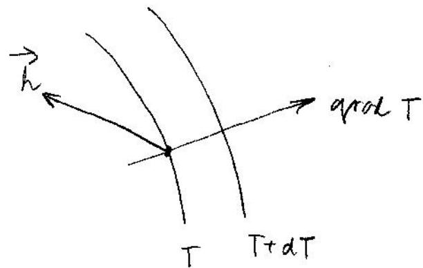
Pr  $\vec{h} = -\lambda \text{grad } T, \quad \lambda [\text{W/mK}], \quad \lambda > 0$
