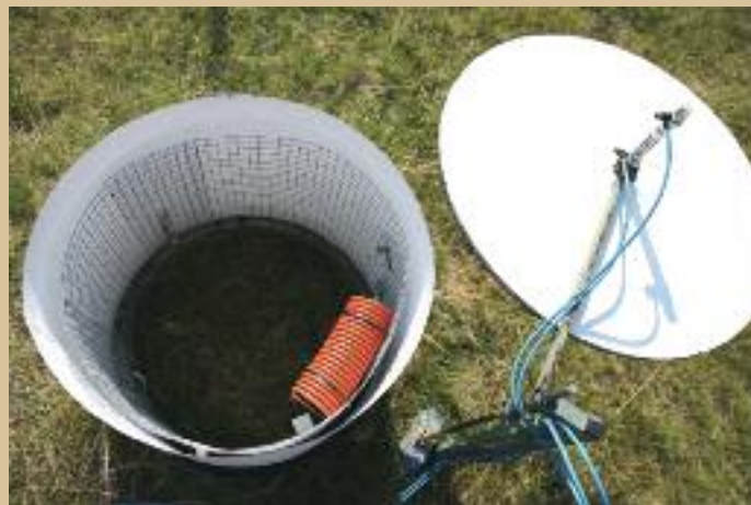
Speciální komory na horské louce se používají pro měření výměny \text{CO}_2 mezi travním porostem a atmosférou.
