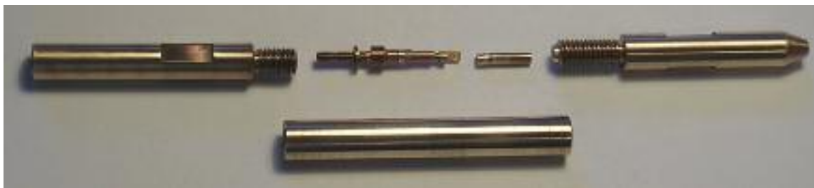
Miniaturní tlaková CuBe cela pro měření magnetických vlastností pevných látek v tlakové oblasti do 1,2 GPa a v polích do 7 T, zkonstruovaná a vyráběná ve FZÚ.
