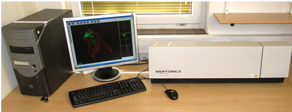
Optický projekční tomograf Bioptonics OPT 3001 v oddělení biomatematiky, Fyziologický ústav AV ČR, v.v.i., areál biomedicinských ústavů Akademie věd, Praha-Krč.
