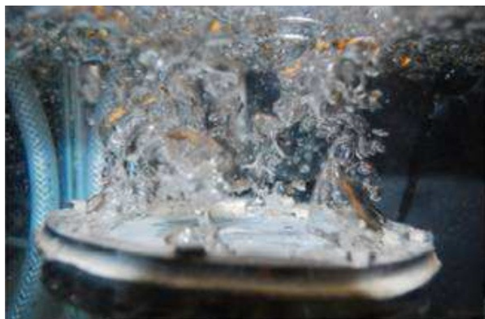
Velké bubliny generované bez fluidického oscilátoru
